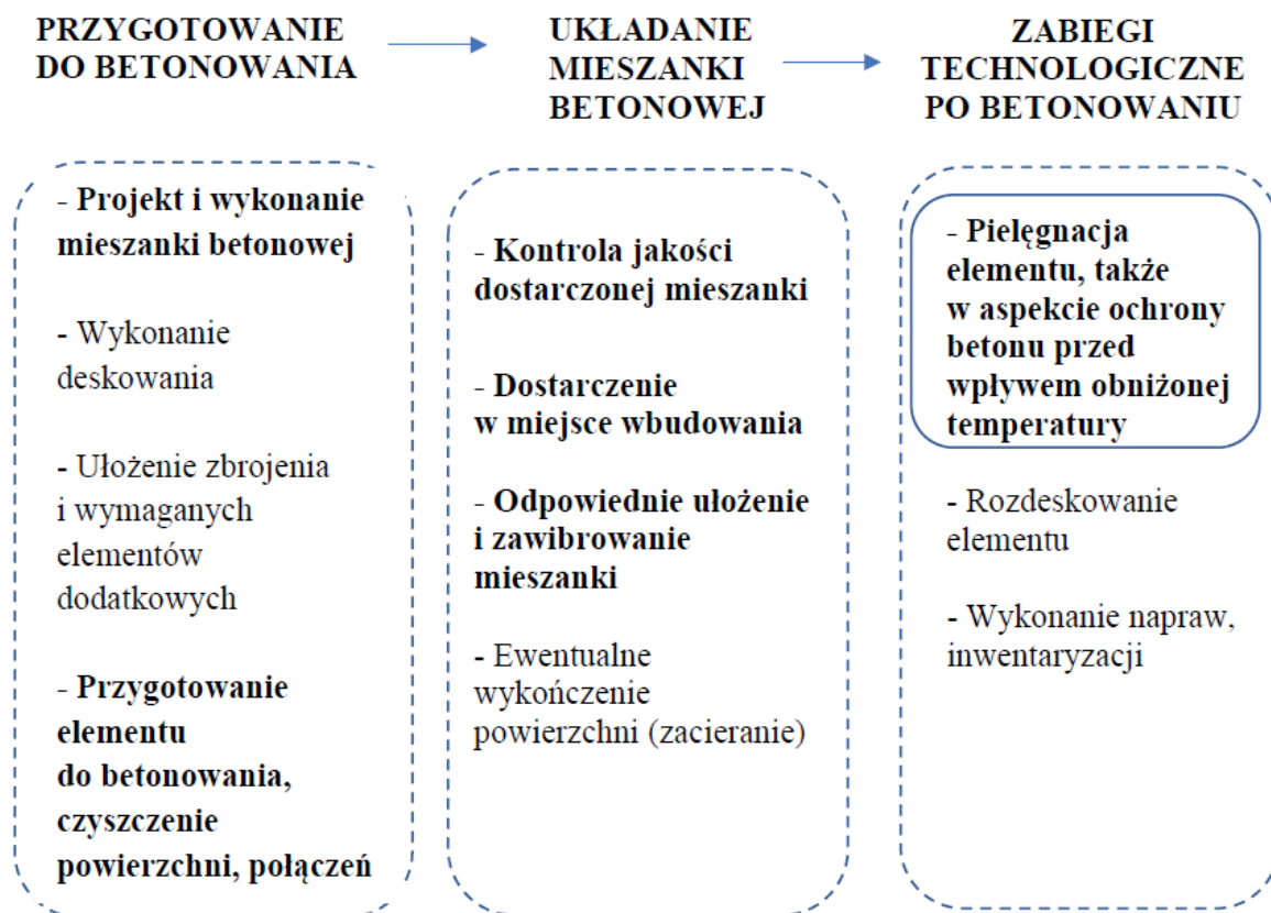
Rys. 3. Etapy wykonywania monolitycznej konstrukcji żelbetowej (opracowanie autorki)
