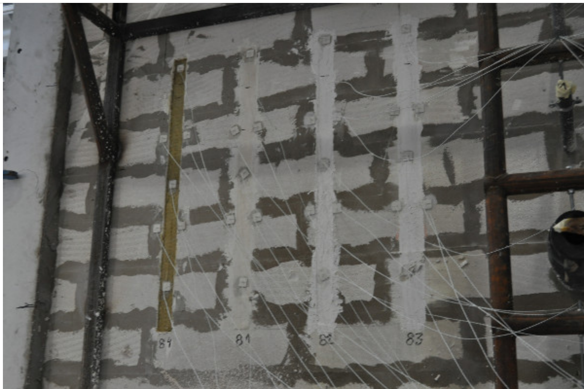
Fot. 3. Widok nienagrzewanej powierzchni elementu próbnego w trakcie badania w zakresie odporności ogniowej (uszczelnienia złączy liniowych w ścianie)
