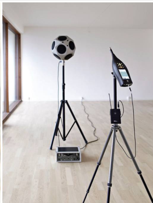
Przykład systemu akustyki pomieszczeń: analizator 2250/2270 ze wzorcowym źródłem dźwięku 4292-L i wzmacniaczem mocy 2734
