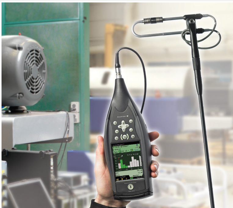
Analizator akustyczny typu 2270 z sondą natężenia dźwięku
