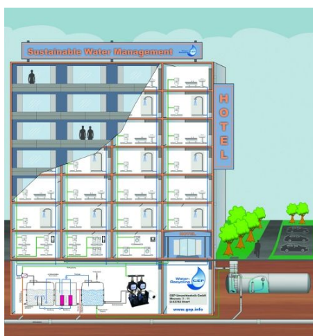
System przetwarzania i wykorzystania wody szarej
